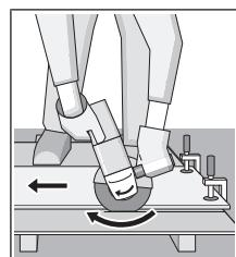
Всегда ведите электроинструмент против направления вращения. В противном случае существует опасность **не-контролированного вырыва**ния инструмента из прорези. При резке профилей или четырехгранных труб начинайте рез на наименьшем поперечном сечении.
