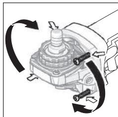
Корпус редуктора может поворачиваться с интервалом в 90°. Этим выключатель может быть поставлен в удобное для работы положение, например, для левши.
