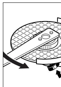
Должным образом затянутую, исправную быстрозажимную гайку можно открутить поворотом кольца с накаткой от руки против часовой стрелки. **Никогда не применяйте для откручивания заклинившей быстрозажимной гайки клещи, обязательно используйте комбинированный ключ.** Беритесь комбинированным ключом, как показано на рисунке.
